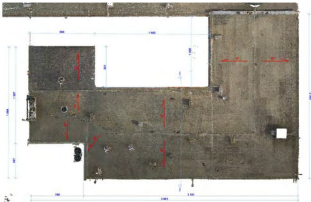
połąć dachowa, na której planowana jest instalacja PV – rzut poglądowy
